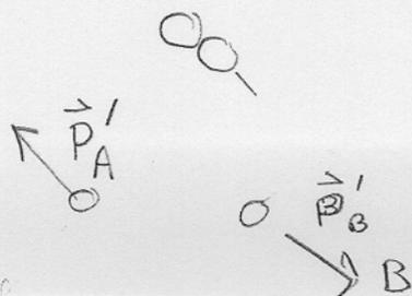
$$m_A \vec{v}_A + m_B \vec{v}_B = m_A \vec{v}'_A + m_B \vec{v}'_B$$
