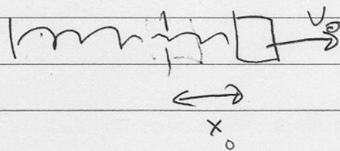
$$x(t) = x_0 \cos(\omega_0 t) + \frac{v_0}{\omega_0} \sin(\omega_0 t)$$
